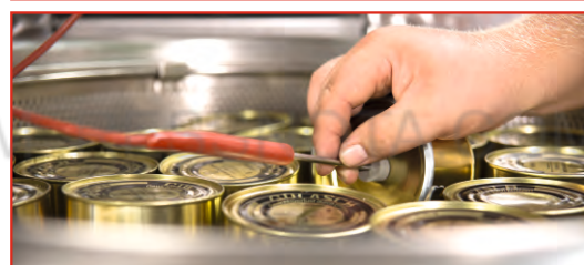
Измерение зондом температуры продукта во время процесса варки.
