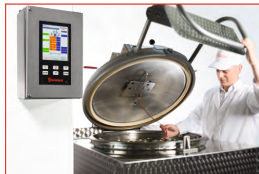
Панель управления системы процесса варки устанавливается отдельно, передает и сохраняет всю информацию и обеспечивает возможность бесконтактного обмена данными.
